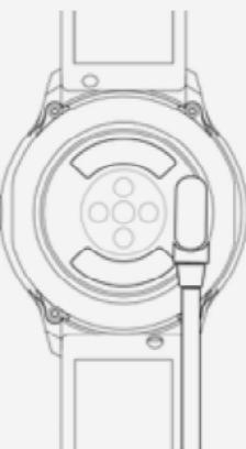
\* O carregamento da bateria do relógio deve-se efetuar conforme a imagem. O carregamento incorreto pode danificar o relógio. Atenção: os dois contatos do cabo USB não podem entrar em contato com o condutor em simultâneo, sob pena do circuito queimar.
