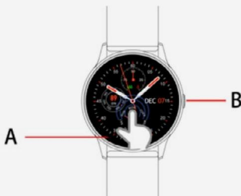
Vous pouvez interagir avec votre montre grâce à l'écran tactile « A » et au bouton poussoir « B » correspondant au bouton « retour ». Un appui long permettra d'allumer et éteindre la montre.
