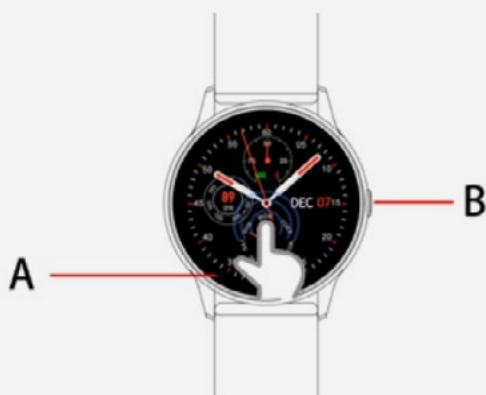
Su reloj se controla mediante la pantalla táctil completa “A” y el botón pulsador “B”, que es el botón de retorno. Mantenga presionado el botón pulsador para encender / apagar.
