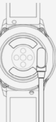
\* La montre se recharge par un système magnétique. Connectez les points aux tiges de chargement à l'arrière du boîtier selon le modèle ci-dessus. La charge débutera automatiquement. Attention à ne pas court-circuiter les deux points de chargement.
