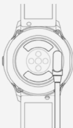
\* Un imán en el cabezal del cargador dirige el cargador a la posición correcta. Los dos contactos del cable USB no deben forzarse para conectarse al conductor en la forma opuesta, ya que puede causar un cortocircuito.
