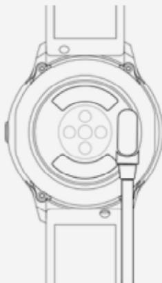
\*Il caricatore è provvisto di una testina magnetica che guida il caricatore nella posizione corretta. I due contatti del cavo USB non devono essere forzati a collegarsi al conduttore in modo opposto in quanto potrebbe causare un cortocircuito.
