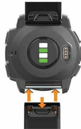
**HINWEIS:** Vergewissern Sie sich, dass das Armband sicher befestigt ist. Die Verriegelung sollte über dem Stift einrasten.
