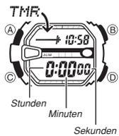
Der Countdown-Timer kann in einem Bereich von einer Minute bis zu 24 Stunden eingestellt werden. Ein Alarm ertönt, wenn der Countdown Null erreicht. Der Countdown-Timer weist auch eine Wiederholungsautomatik und einen akustischen Ablaufsignalgeber auf, der den Ablauf des Countdowns signalisiert.
