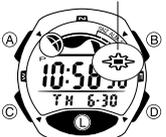
Il display dell'orologio è illuminato da un LED (diode a emissione luminosa) e da un pannello a fibra ottica per una facile visione delle indicazioni al buio. La funzione di illuminazione automatica dell'orologio fa accendere automaticamente l'illuminazione quando si orienta l'orologio verso il proprio viso.
